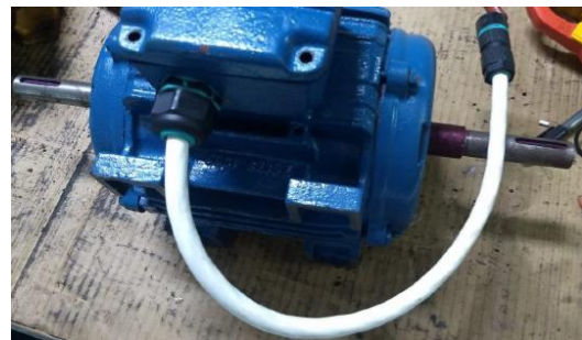
Cabo + Conector desconectável para troca rápida de motor
