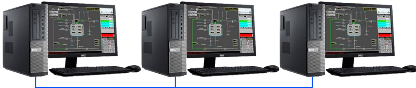
Estações de Supervisório FTView SE
