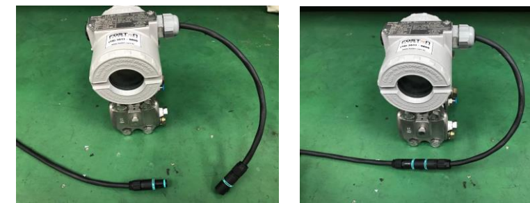
Conector desconectável para intervenções para manutenção ou calibração de instrumentos
