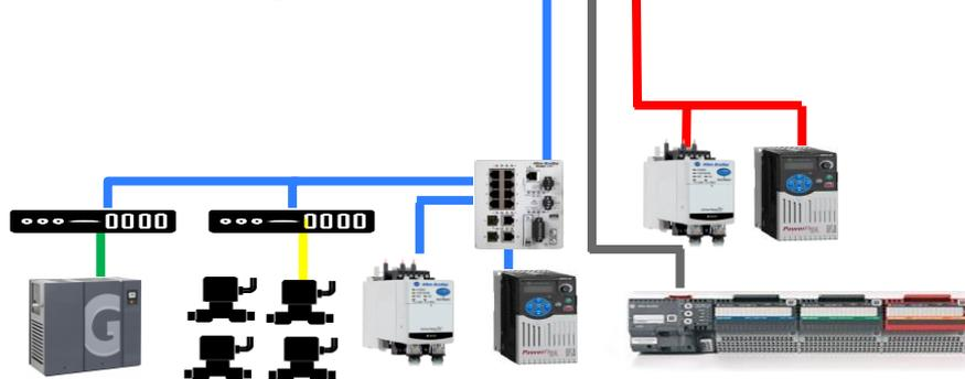
Equipamentos, módulos de entradas e saídas e dispositivos ligados aos CLPs via redes diversas
