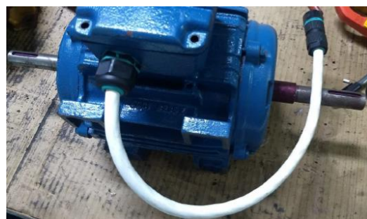
Cabo + Conector desconectável para troca rápida de motor
