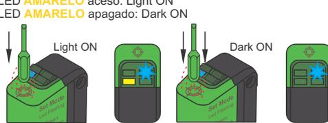
3 - Para armazenar o modo de operação, aproxime novamente a chave magnética por 3s. O LED AMARELO pisca 3 vezes, indicando que o sensor armazenou a configuração. Após o término da configuração, o sensor volta para o modo de operação.
