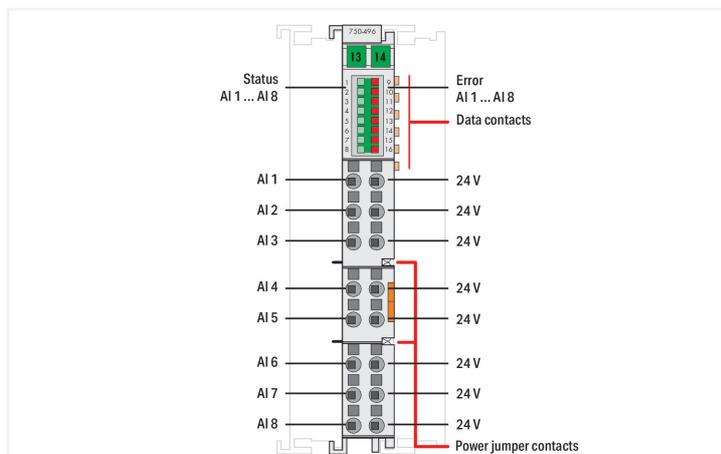
Este módulo de entrada analógica processa sinais padrão de 0-20 mA, 4-20 mA e 3,6-21 mA (Namur NE43).
